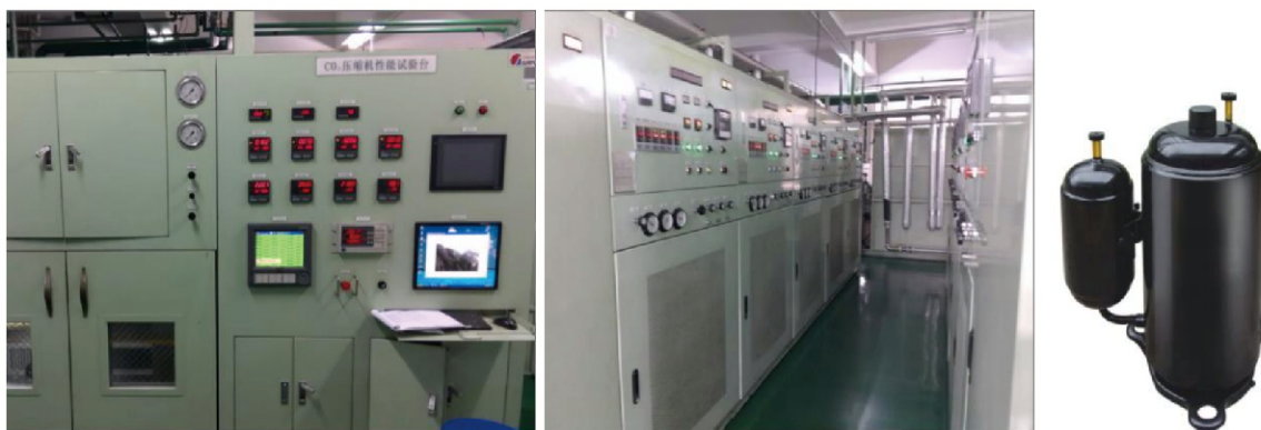
图4-16 GMCC美芝的CO 2 压缩机专用测试设备及产品
