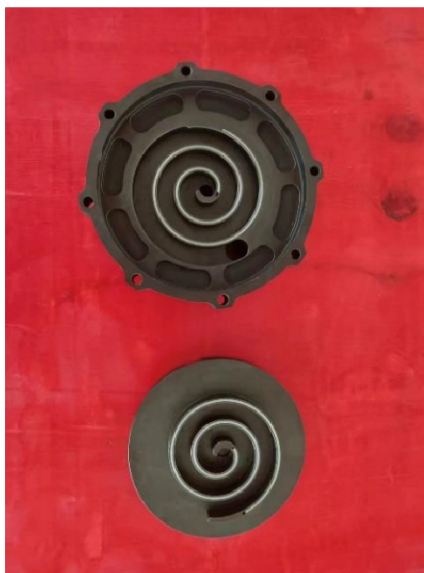
图4-14 圣三松公司CO 2 跨临界涡旋压缩机涡旋盘
